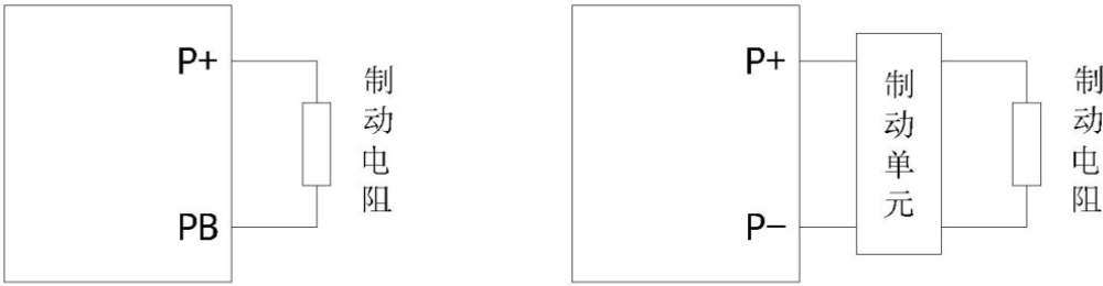
图 2-7 制动电阻连接示意图
