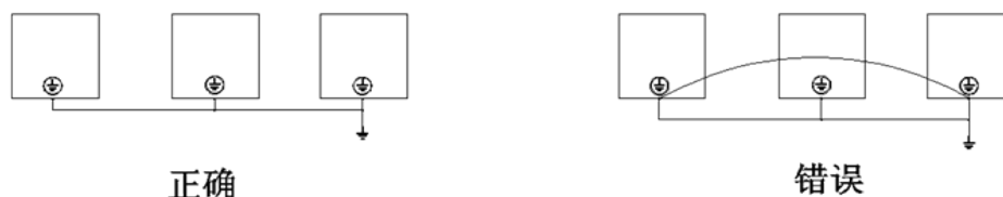
图 3-5 接地线接法示意图
